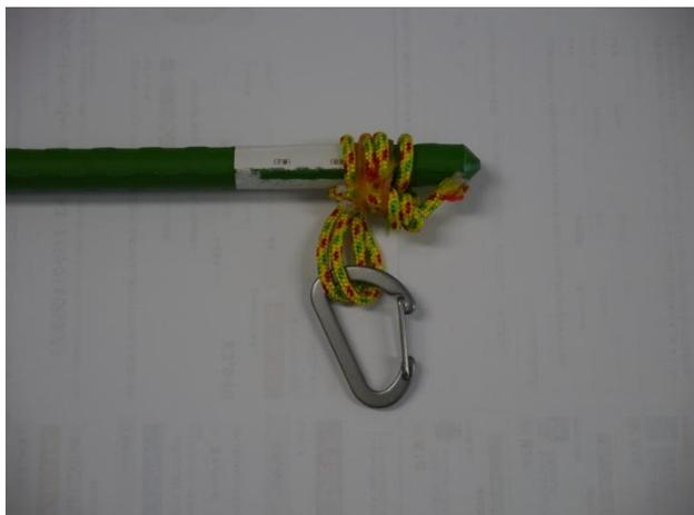
第5に、大型路上広告の設置場所である、2階メディアセンターと3階図書館の部分の電動ブラインドの下端にも、ナイロンロープで同様の2重のループを取り付け、先の簡易カラビナを介して、電動ブラインドの下端に大型ユニットを接続する。【図一6】
