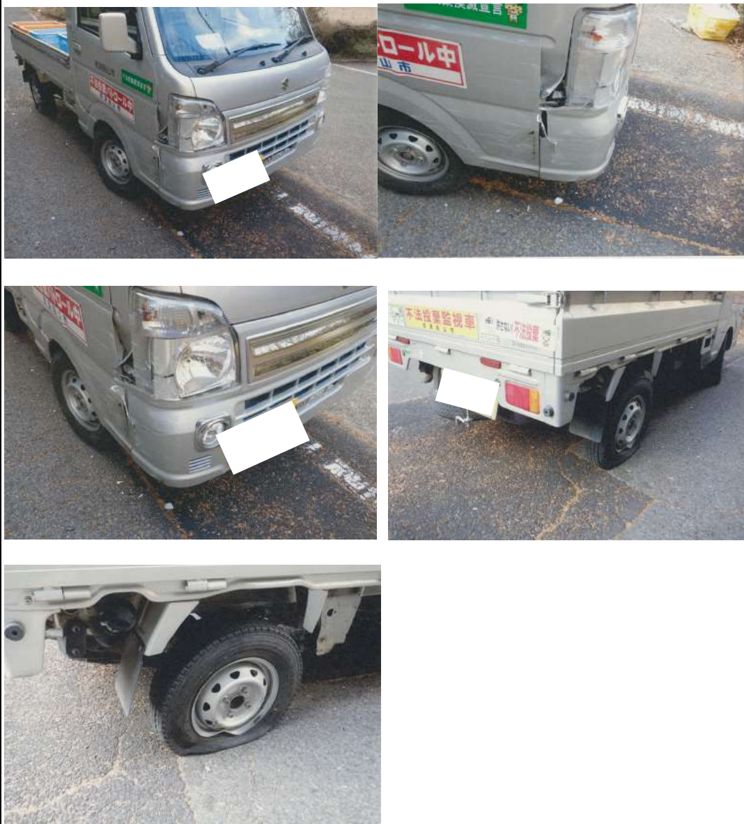
説明 公用車損傷部位（右フロントフェンダー、右後タイヤホイール）
