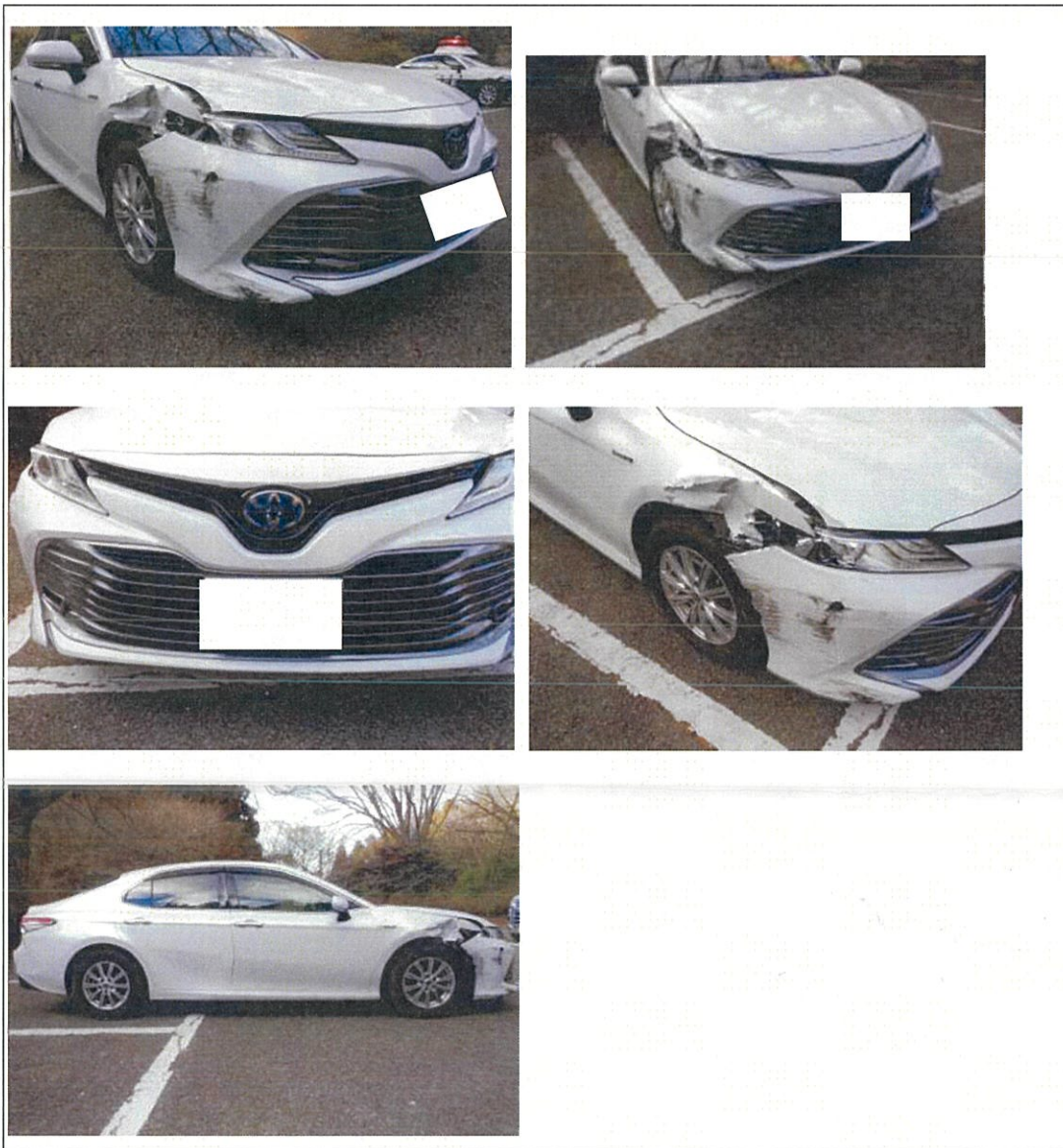
説明 相手車損傷部位（右フロントフェンダー）
